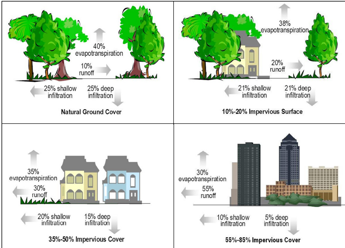
Abb. 22: Veränderung des Wasserhaushaltes durch Urbanisierung (nach US-EPA 2005)
